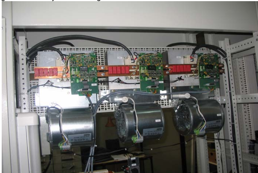
Prikaz bloka poluprovodničkog trofaznog tranzistorskog mosta
