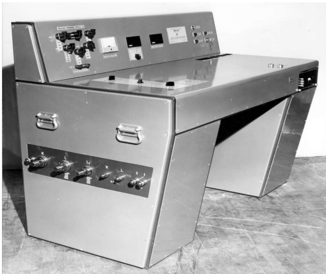
Slika 2. Uređaj za automatsko ispitivanje tačnosti strujnih transformatora ASK-1 (1975.godina)
