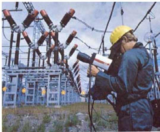
Slika 5. Termovizijski komplet AGA 782 sa priborom za kolor prezentaciju
