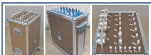
Еталон струјни трансформатори
